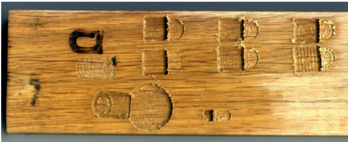
Abb.5: Zu betrachten sind die 6 Lager rechts oben. Diese sind jeweils mit einem Rosenbohrer mit Durchmesser 4,5 mm ausgefräst worden (Radius r_1 = 2,25 mm, man hat festgelegt: r_2 = 2 mm). Die obere Reihe in Horizontalfräsung und die untere Reihe in Vertikalfräsung. Von links nach rechts haben wir den Bahnabstand r_3 und das vertikale Offset r_4 variiert:
