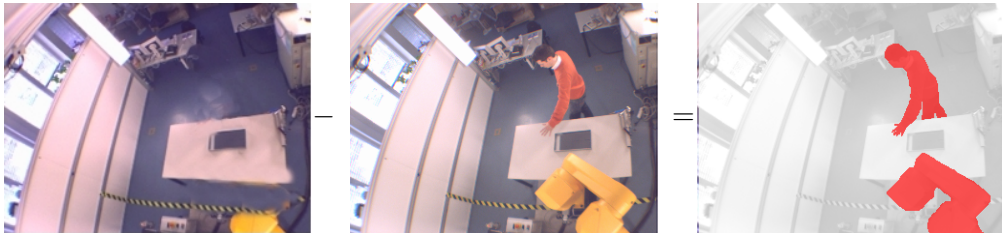
Abbildung 2.3: Background-Subtraction-Verfahren: Erstes Bild ist Referenzbild, zweites Bild ist zu einem späteren Zeitpunkt aufgenommen worden, drittes Bild ist Differenzbild (Bilder am Lehrstuhl „AI 3“ verfügbar)
