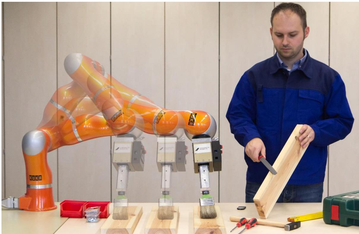
Abbildung 1: Die einmal vom Werker demonstrierte Aufgabe wird vom Roboter automatisch für jedes Werkstück an den unterschiedlichen Stellen ausgeführt und entlastet somit den Werker. [Foto: Uni Bayreuth]
