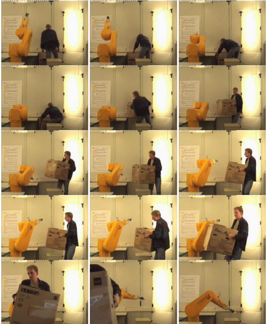
Abbildung 75: Aufräumen der Arbeitszelle. Der Mensch betritt den Arbeitsraum während des Roboterbetriebes. Er führt seine Aufgabe durch und blockiert dabei zeitweilig verschiedene Zielkonfigurationen des Roboters. Der Roboter versucht sein Ziel so gut wie möglich zu erreichen. Nachdem der Mensch die Zelle verlassen hat, setzt der Roboter die Arbeit fort.
