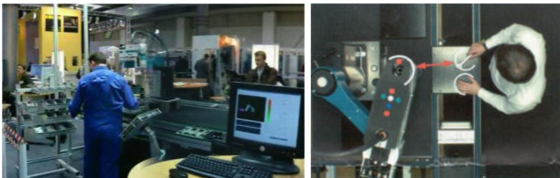
Abbildung 10: Modellarbeitsplatz zur gemeinsamen Montage von Objekten durch menschlichen Arbeiter und Roboter (links, Foto: Autor)
