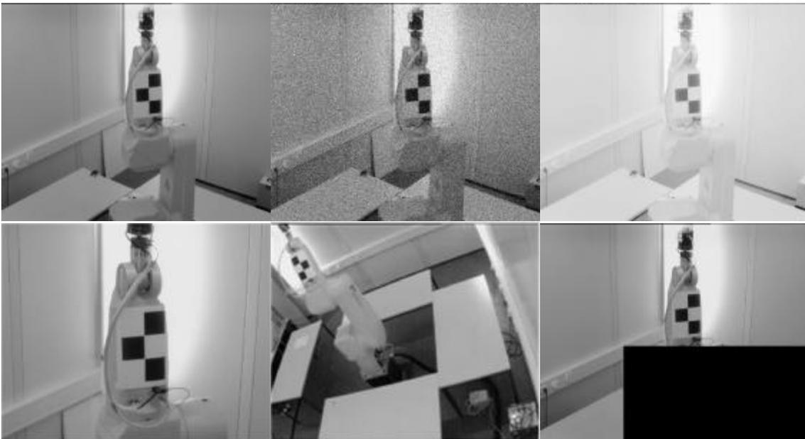
Abbildung 65: Sensorfehler bei Kamerabildern. Erwartetes Bild, verrauschtes Bild, falsche Beleuchtung, falsche Zoomeinstellung, falsche Kameraposition, teilweise blockierter Sichtbereich (von links nach rechts und von oben nach unten)
