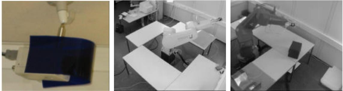
Abbildung 41: Effekt eines Farbfilters auf den Grauwert des Roboters. Vor der Kamera wird ein Blaufilter angebracht (links). Ohne Farbfilter ist der Grauwert des orange-gelben Roboters sehr ähnlich dem Grauwert des Hintergrundes (Mitte). Mit Farbfilter ist der Roboter deutlich dunkler (rechts).
