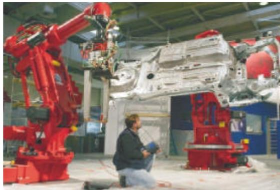
Abbildung 3: System zum Halten von schweren Werkstücken (aus [6])
