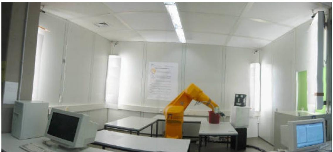
Abbildung 27: Foto der realisierten Zelle zur sicheren Mensch-Roboter-Koexistenz. Vier Graubild-Kameras sind in der dargestellten Kamerakonfiguration in den oberen Ecken installiert und überwachen den gesamten, verwendeten Arbeitsraum des Roboters.
