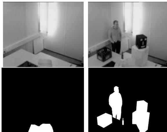
Abbildung 30: *Obere Reihe: Kamerabilder von leerer Zelle (links) und Zelle mit Hindernissen (rechts)*
