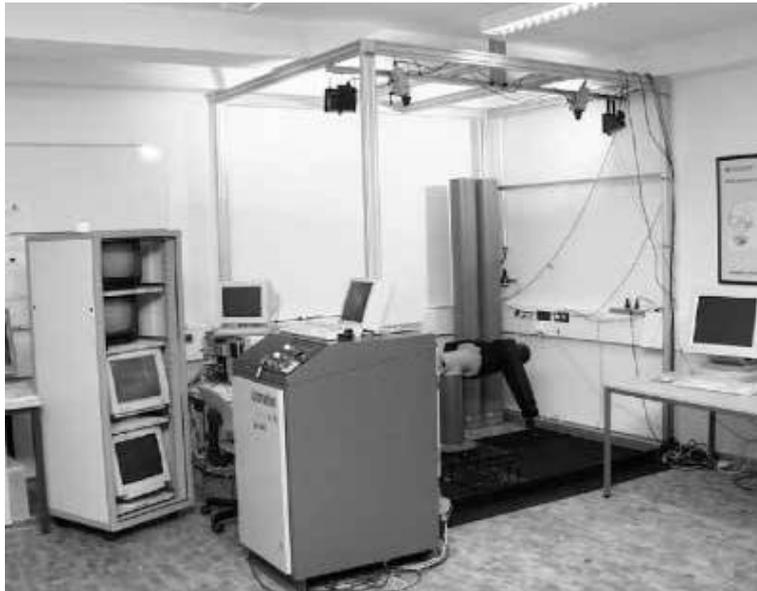
Abbildung 13: Roboterzelle mit stationären Kameras zur online Kollisionsvermeidung (aus [Bischoff99])
