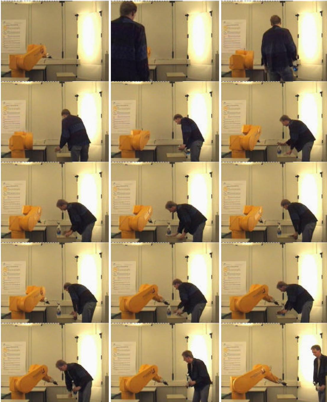
Abbildung 74: Vorbeugende Wartung einer Maschine im Arbeitsraum. Der Mensch betritt während des Roboterbetriebs die Zelle. Er führt die Wartungsaufgabe durch (hier: Putzen des Tisches) und verlässt den Arbeitsraum wieder. Der Roboter erkennt, dass die Zielkonfiguration bei der Maschine belegt ist und wartet, bis der Mensch aus dem Weg ist und setzt dann seine Arbeit fort.
